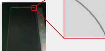
レーザー照射 500mm/s ±20μm R5mm
